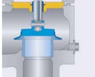
Диск с уплотнительной пластиной J44: PTFE-FDA J48: PCTFE J49: SP
