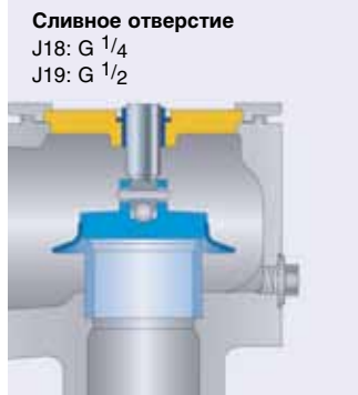
Сиффон из нержавеющей стали J68: Открытый кожух J78: Закрытый кожух
