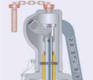
Винт-блокиратор J69: H4 J70: H2
