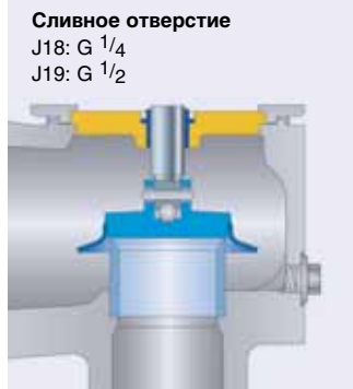
Диск с уплотнительной пластиной J44: PTFE-FDA J48: PCTFE J49: SP
