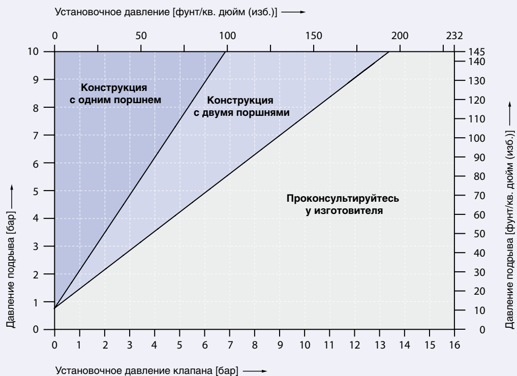
Диаграмма подбора устройства подрыва Н8, размер II. d_0 60 мм / 2,362 дюйма
