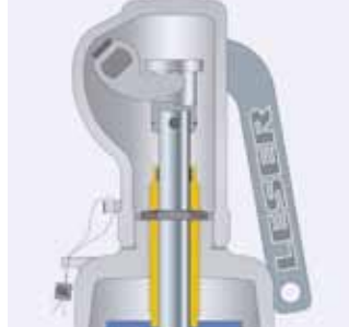
Герметичный рычаг H4 H4
